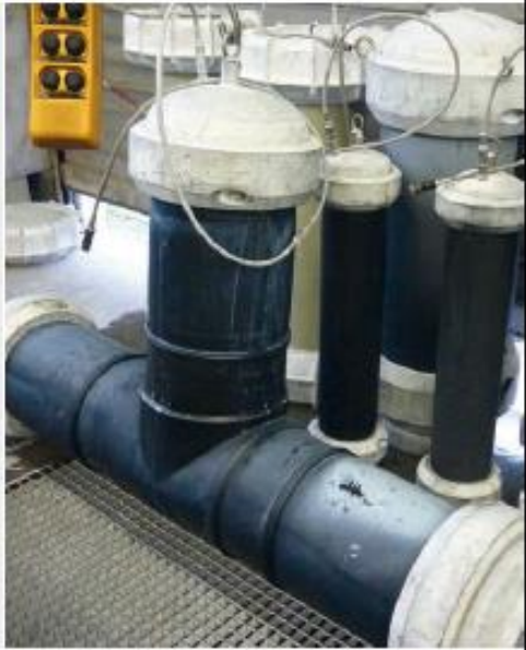
SIMONA® PE 100 FM-Line test specimens
